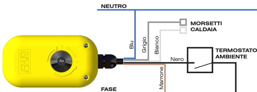
La presenza del microinterruttore ausiliario (contatto pulito) interno collegato ai cavi grigio e bianco, essendo indipendente dal circuito del servocomando, permette l'allacciamento di più servocomandi in parallelo per governare un'unica apparecchiatura come ad esempio la pompa o la caldaia. Nel caso si debba comandare l'avviamento della pompa già presente in caldaia, basta collegare i cavi di colore grigio e bianco ai due morsetti predisposti (sulla caldaia) per l'allacciamento al termostato.
