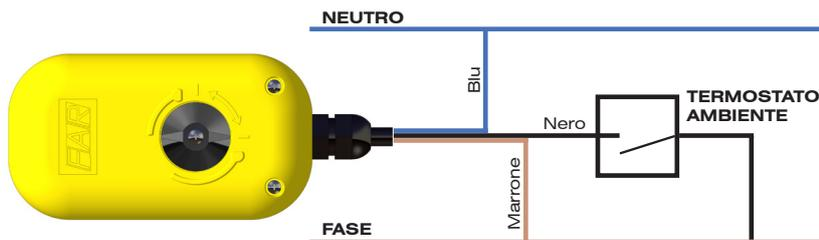
Collegare il cavo di colore blu al neutro dell'alimentazione, il cavo di colore marrone alla fase diretta ed il cavo di colore nero al termostato ambiente.
