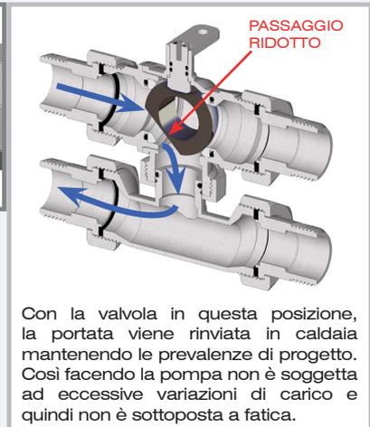
Con la valvola in questa posizione, la portata viene rinviata in caldaia mantenendo le prevalenze di progetto. Così facendo la pompa non è soggetta ad eccessive variazioni di carico e quindi non è sottoposta a fatica.
