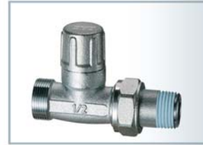
Art. 1300 Detentore diritto cromato - Attacco intercambiabile per tubo in rame, plastica e multistrato - Mis.: 3/8" - 1/2"
