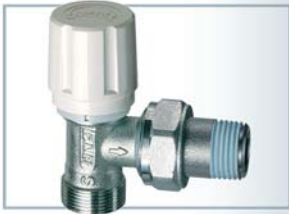
Art. 1610 Valvola termostattizzabile a squadra cromata - Attacco intercambiabile per tubo in rame, plastica e multistrato - Mis.: 3/8" - 1/2"
