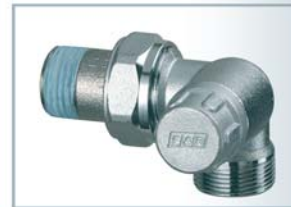
Art. 1116 Detentore a squadra cromato sinistro - Attacco intercambiabile per tubo in rame, plastica e multistrato - Mis.: 3/8" - 1/2"
