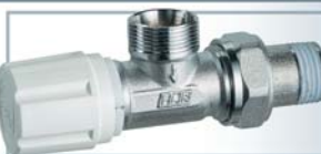
Art. 1117 Detentore a squadra cromato destro - Attacco intercambiabile per tubo in rame, plastica e multistrato - Mis.: 3/8" - 1/2"
