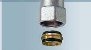
Riduzione che permette di passare da un filetto FAR W24x19 ad un filetto 1/2" femmina
